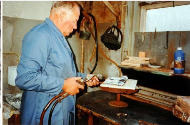
Afb. 4 In de werkplaats van de Zilverfabriek Gebr. Huisman. Uitgloeien van bakken van papepels.
