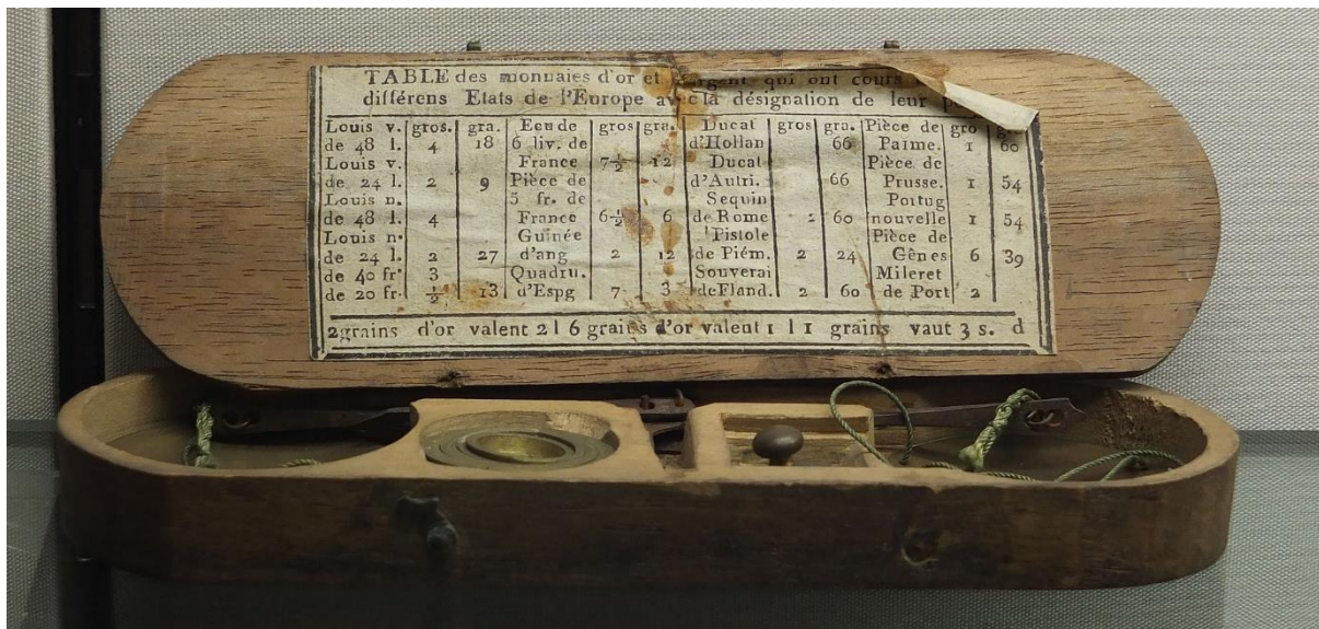
Muntgewichtendoos met weegschaal en diverse gewichten. Staal en koper 1780-1820.
